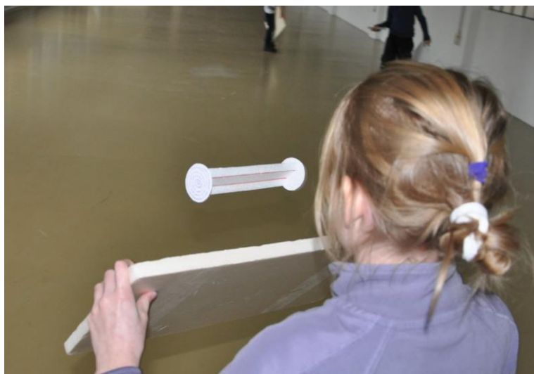
Ein Rotationsflügel fliegt am besten bei etwas flacher gehaltener Platte im Bereich des oberen Plattenrandes
